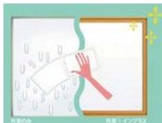
既存の窓と、内窓として取付けたインプラス、さらにその間に生まれる新しい空気層が室外と室内をしっかりと隔てる構造に。大きな断熱効果で外気温の影響を受けにくくし、結露の発生を抑えます。
